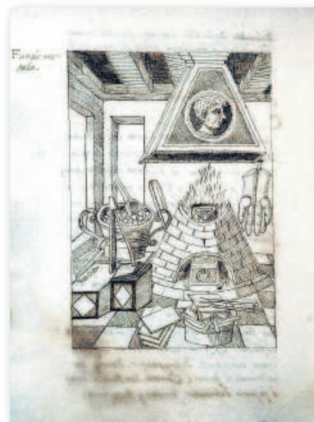
Qui sopra: Forno per la fusione dei metalli (Ms. 230, c. 27 v.) In alto a sinistra: Forno per la purificazione dell'oro (Ms. 230, c. 17 v.).
